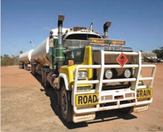
Die Herren der Highways: Roadtrains ziehen bis zu vier Anhänger mit einem Gesamtgewicht von über 200 Tonnen.
