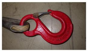
Solche Haken sind unsicher, auf deren Einsatz sollte verzichtet werden! Leider werden viele Windenseile genau damit ausgeliefert.
