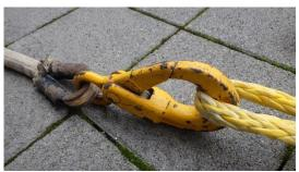
Automatikhaken welche sich nur durch die Betätigung der Sicherung öffnen lassen und unter Zug sofort schliessen. Diese Haken kosten oft weniger als CHF 100.- müssen aber korrekt dimensioniert sein. Wichtig!! Auch für Haken gilt Sicherheitsfaktor 2!!! Achten Sie auf Güteklasse 10!
