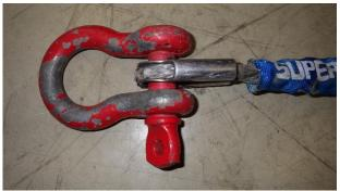
Die preiswerteste Variante für ein geschlossenes Windensystem ist ein ganz normaler Stahlschäkel am Windenseil. Kostet in der Regel ca CHF 25.- und ist sicher.
